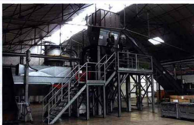
2. À gauche, le convoyeur qui apporte les cartouches dans le premier broyeur est capoté afin de récupérer le toner. Le premier broyeur comprend deux arbres.
