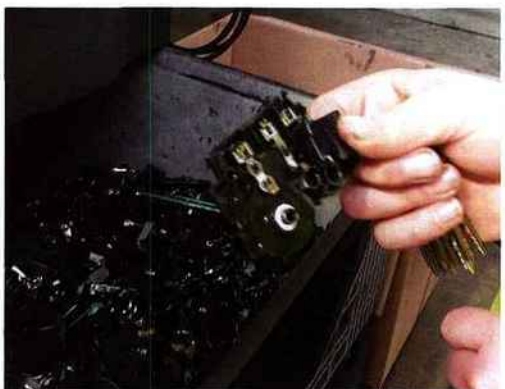
8. L'outil ne pousse pas les démantèlements au maximum. Les flasques de certaines cartouches associent matières synthétiques et inox.
