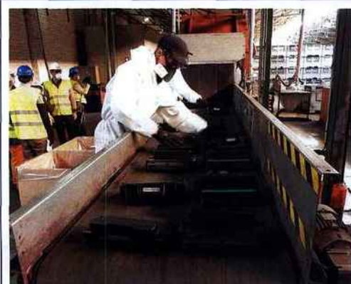
1. Les lots de cartouches sont classés par marque et par modèle sur un autre site ClozDloop. Chaque produit-type conduit à affiner les réglages des différentes machines de la chaîne de traitement.
